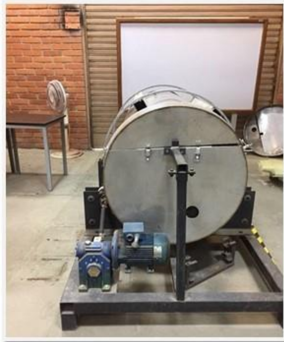
Fig.10. Equipo Tambor rotativo para el secado de granos por medio de radiación infrarroja
