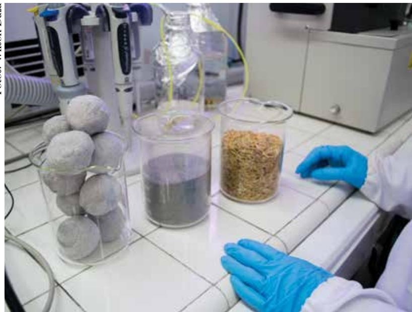
La proporción de uso de los *pellets* abrasivos es de 1:5 que corresponde a 5 kilogramos de material abrasivo por kilogramo de prenda y 25 litros de agua. El lavado se hizo en las mismas condiciones para ambos abrasivos (piedra pómez y *pellets* abrasivos de CCA) a una temperatura de 30°C durante 60 minutos, explica Betancur Vélez.
